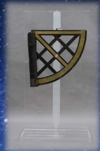
象限儀（仙台市天文台所蔵） 江戸時代に星の高度を測る時に使用されたもので、精密に測るための副尺が備えられている。
